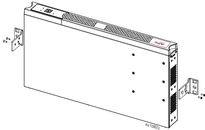
**2 Примечание.** Когда это возможно, закрепляйте два болта в стойке каркаса стены. Если закрепление в стойке каркаса невозможно, используйте расширяемое анкерное крепление. Крепежное оборудование не входит в комплект; рекомендуется использовать шурупы под ключ 25 дюйма x 2 дюйма. Устанавливайте ИБП в любом из показанных положений.
