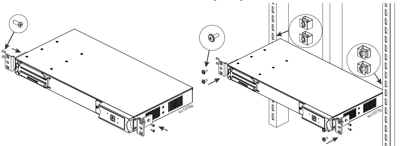
**3** Затяните зажимные гайки на стойке и закрепите кронштейны с помощью прилагаемых винтов.
