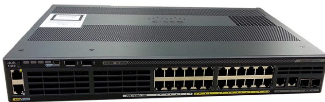
Рис. 4. Безвентиляторный тихий 24-портовый коммутатор с питанием PoE
