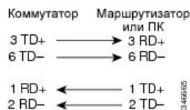
Рисунок 47: Схема перекрестного кабеля с двумя витыми парами
